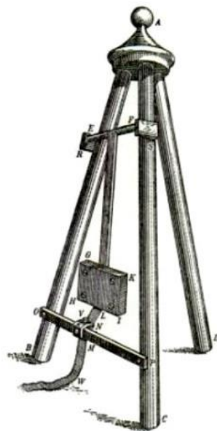
Figura n.º 1: Péndulo de Robins (Fuente: Robins, 1742: s. p.).
