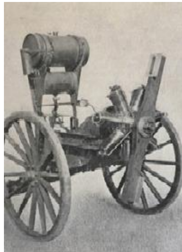
Banco de pruebas de motores realizado por motoristas.
