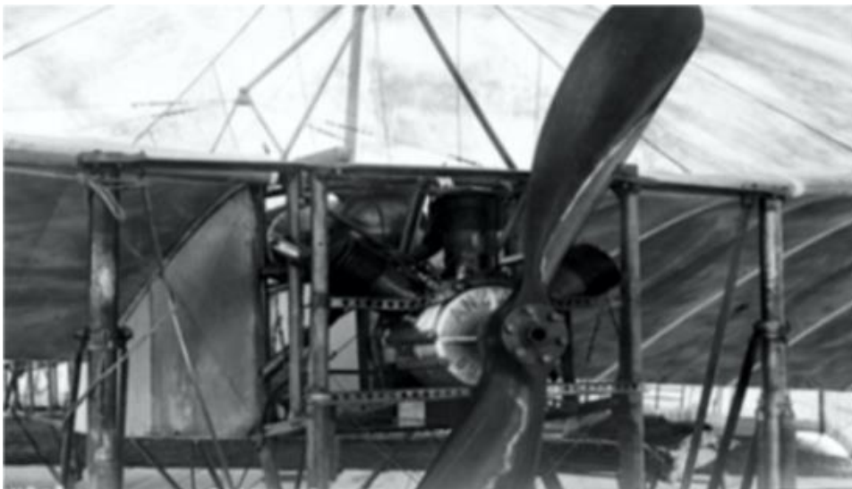
Blériot XI equipado con motor Anzani. Se puede apreciar la fragilidad del aparato.
